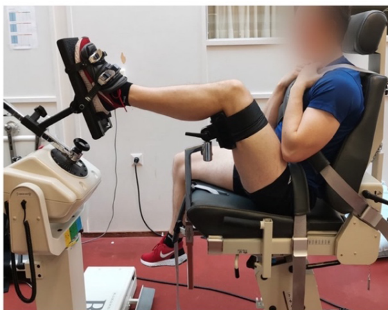
شکل ۵. اندازه گیری حداکثر گشتاور اینورتوری و اورتوری
