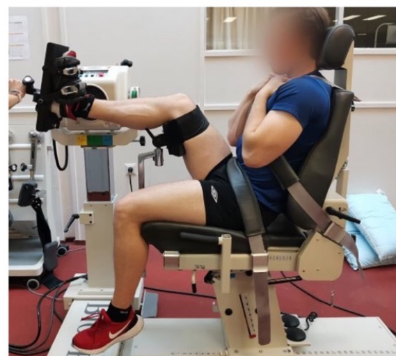
شکل ۴. اندازه گیری حداکثر گشتاور دورسی فلکسوری و پلننار فلکسوری
