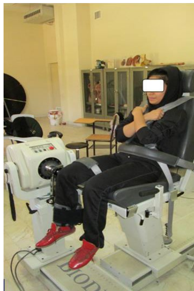
تصویر ۱. نحوه قرارگیری ورزشکار بر روی دستگاه بایودکس ایزوکینتیک
