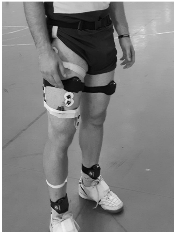
تصویر ۱: چگونگی نصب الکترودها و سنسورها روی پای آزمودنی
